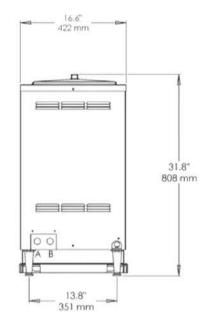
A 5/8" SUCTION LINE QUICK DISCONNECT B 3/8" LIQUID LINE QUICK DISCONNECT
